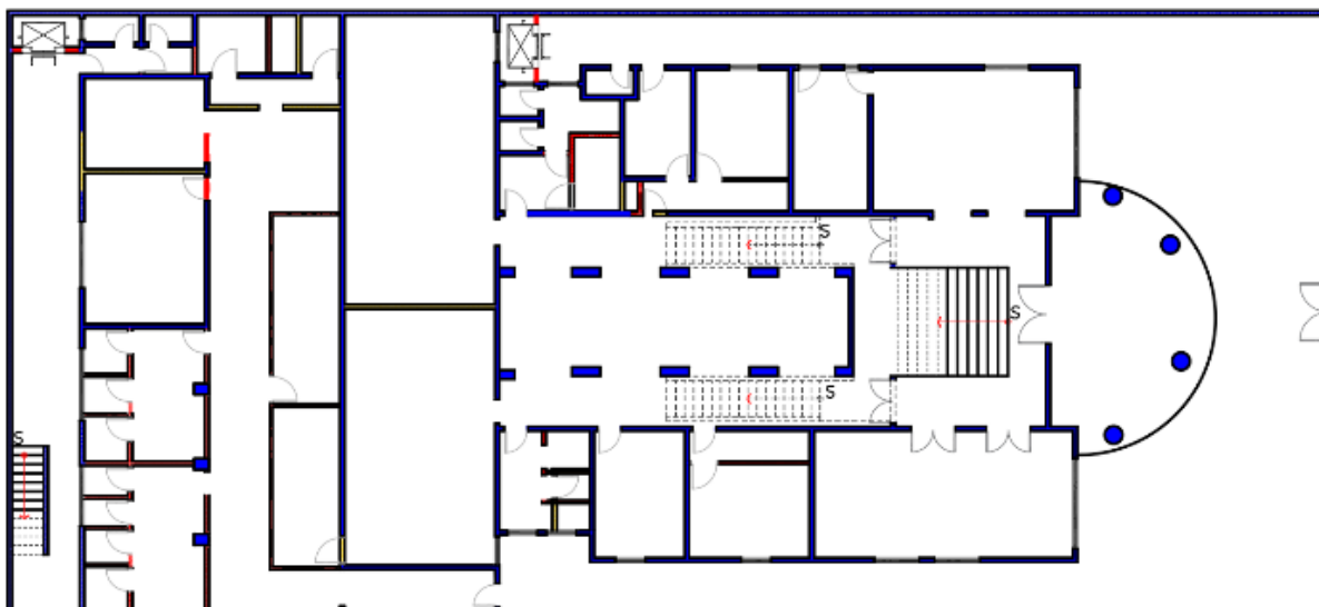
Figura 16. Planta baixa do pavimento térreo do edifício do Automóvel Clube de Bauru - remodelação sendo: a cor azul a manter, a cor amarela a demolir e a cor vermelha a construir (produzido pela autora).
