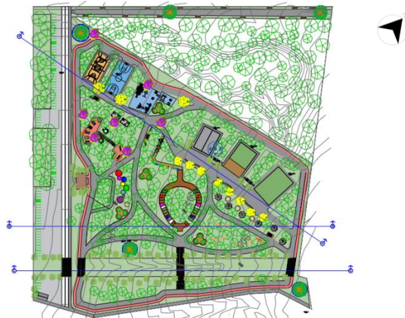
Figura 8. Implantação geral do parque elaborado a partir das curvas de níveis, para que não sofresse grandes alterações topográficas.
