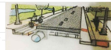
SUGESTÃO DE PAVIMENTAÇÃO COM DRENAGEM, ONDE HÁ ACESSIBILIDADE POR MEIO DA CICLOVIA, CALÇADA, ILUMINAÇÃO E ARBORIZAÇÃO ADEQUADAS, PRIORIZANDO UTILIZAÇÕES ECOLÓGICAS COMO LED, CALÇADA DE CIMENTO INTERTRAVADO QUE FACILITA A DRENAGEM E CANTEIRO COM ARBORIZAÇÃO.
