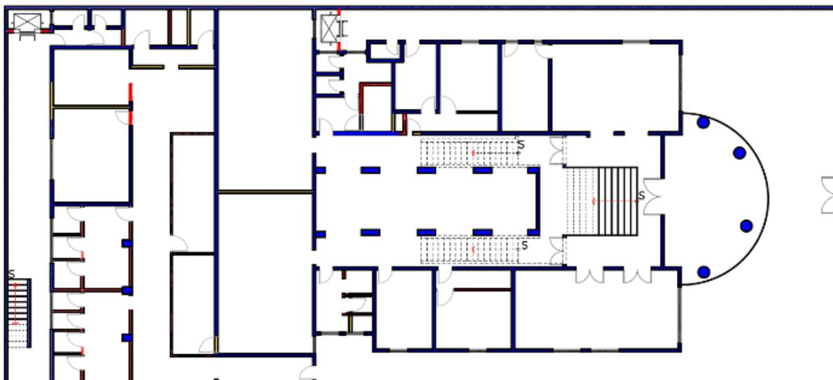
**Figura 16.** Planta baixa do pavimento térreo do edifício do Automóvel Clube de Bauru - remodelação sendo: a cor azul a manter, a cor amarela a demolir e a cor vermelha a construir (produzido pela autora).
