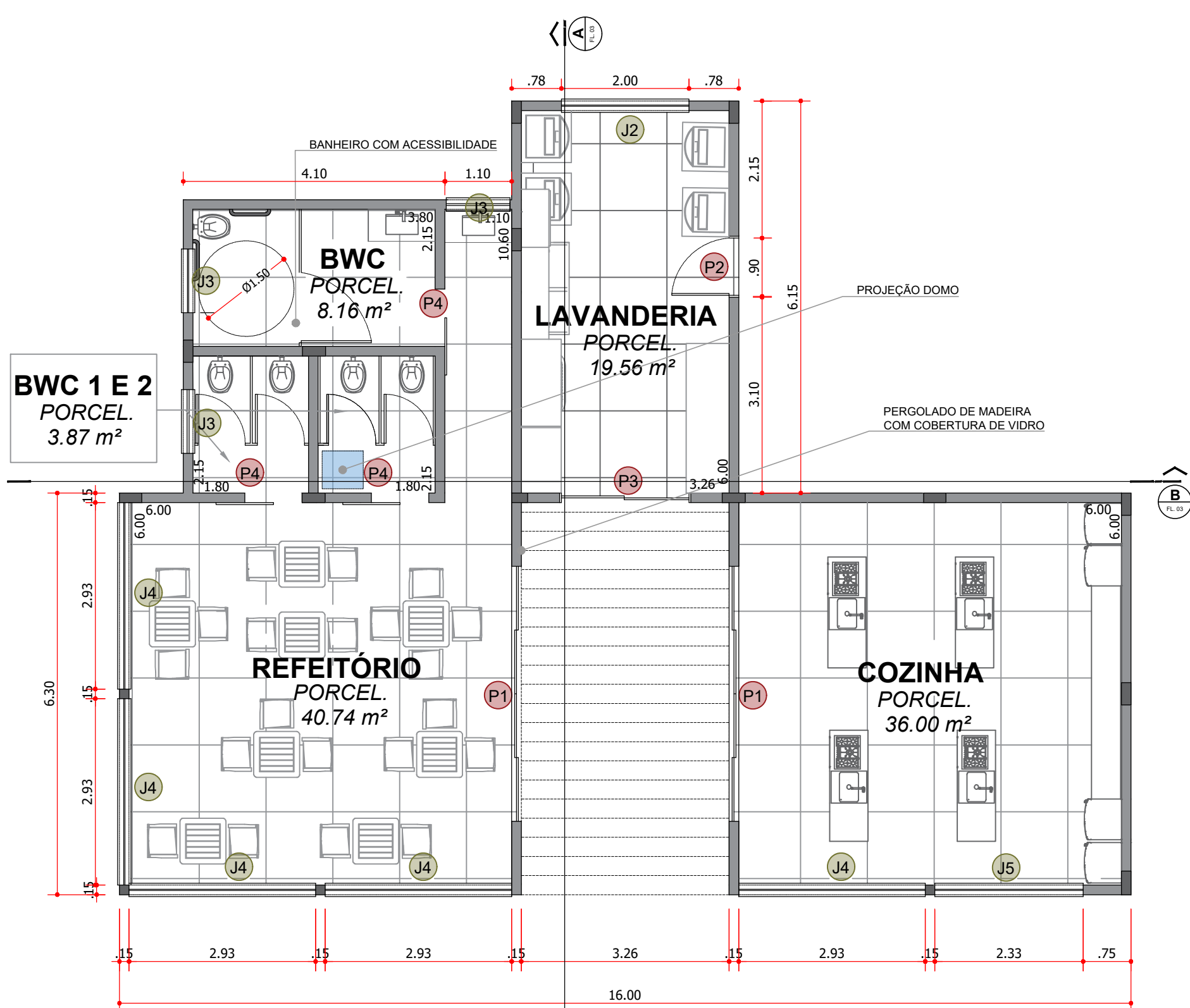
PLANTA BAIXA ESCALA 1:75
