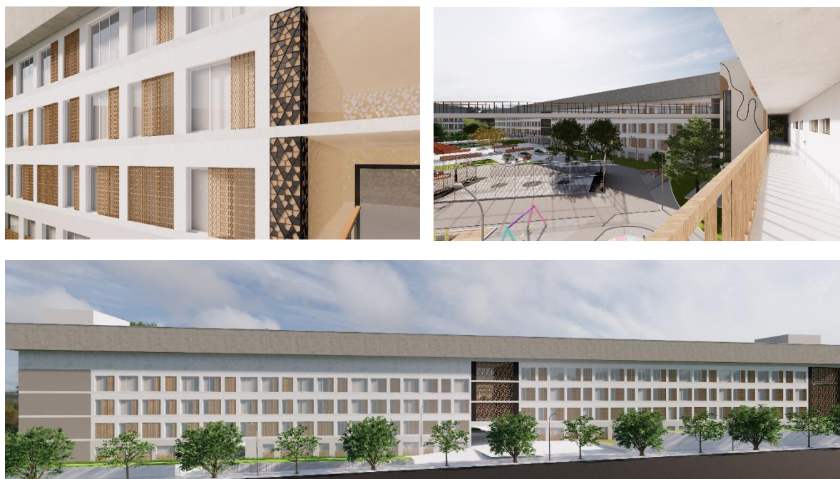
Figura 16, 17 e 18. Maquete eletrônica – Fachadas com painel de muxarabi móvel (Produção autoral)
