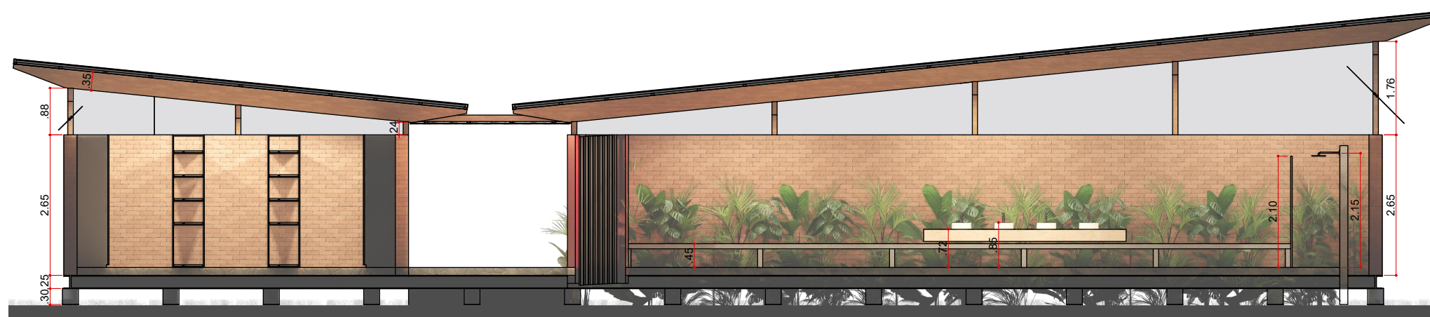
CORTE A - BANHEIROS/VESTIÁRIOS E DEPÓSITO GERAL ESCALA 1:100
