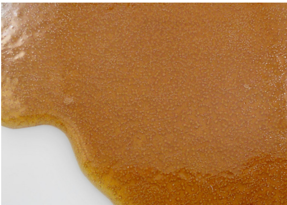
Figura 12: Impermeabilização com poliuretano vegetal
