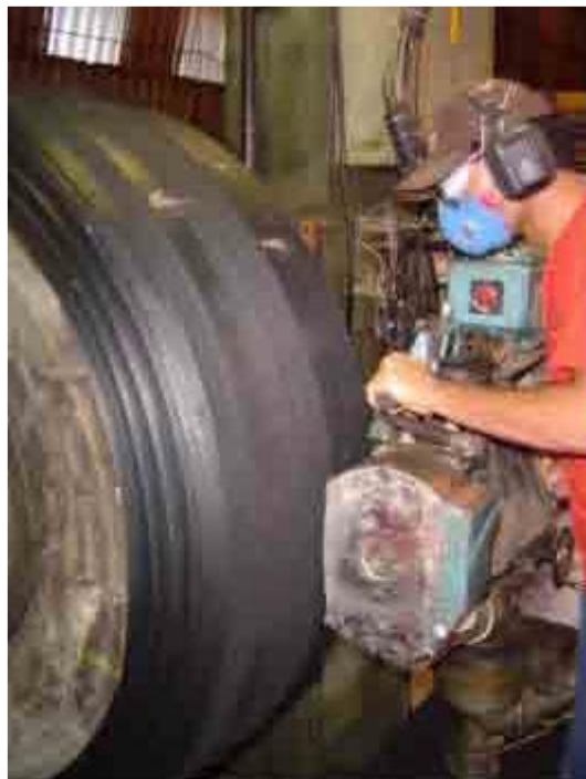
Figura 2: Detalhe da raspagem do pneu à ser recauchutado
