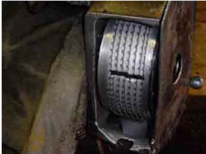
Figura 3: Detalhe da ferramenta rotativa de raspagem de pneus
