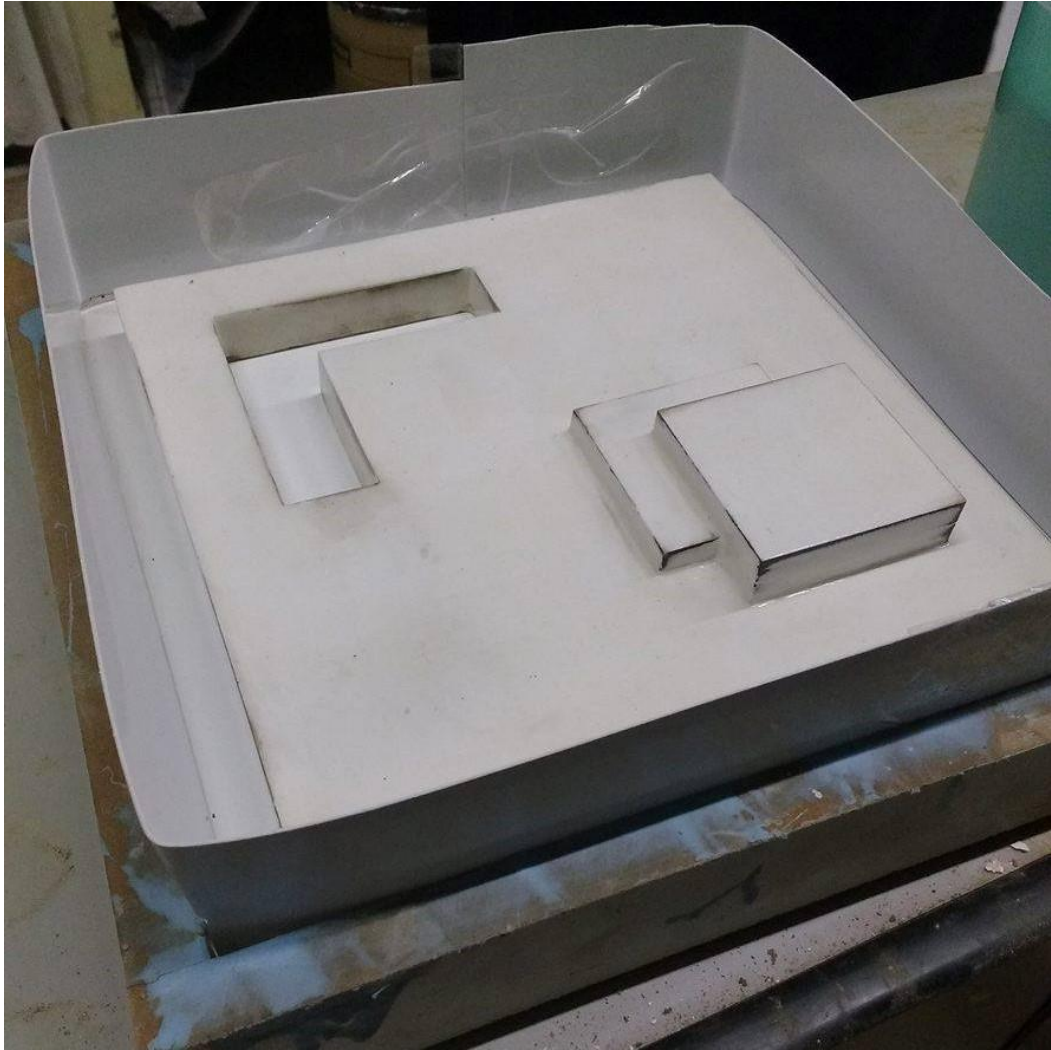
Figura 58: Preparação da peça para receber o silicone.
