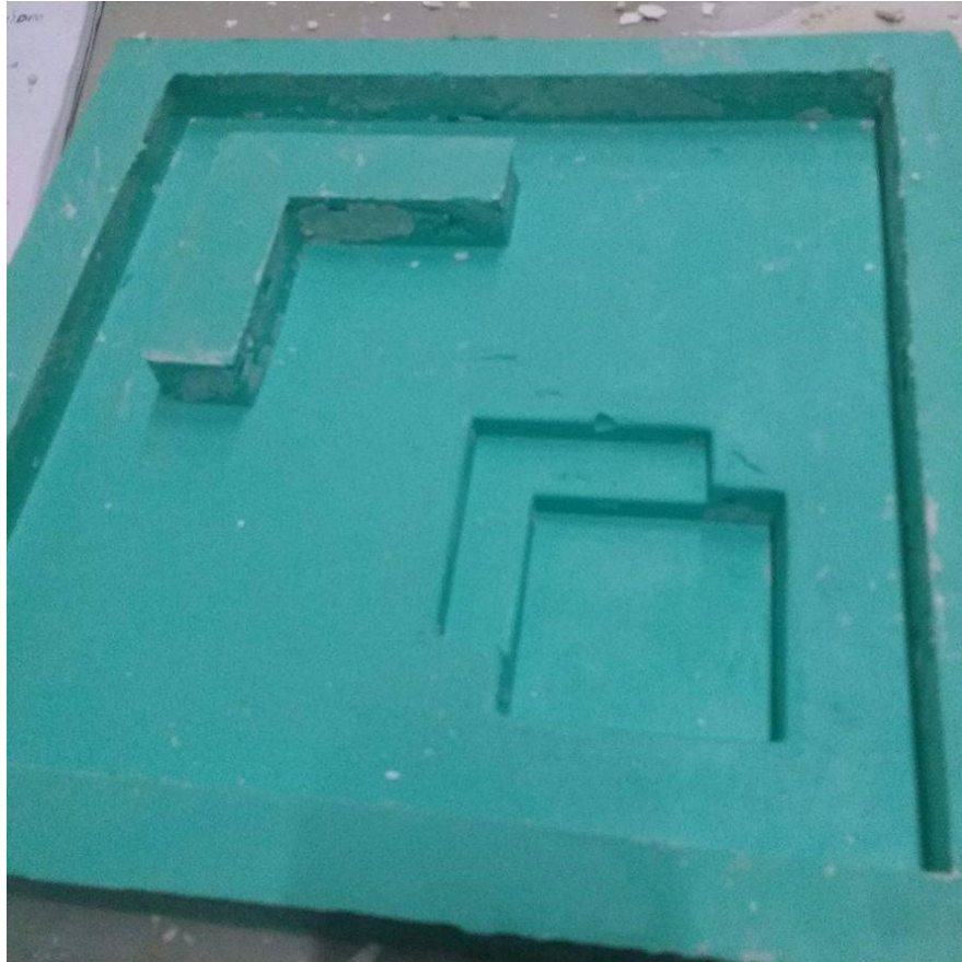
Figura 70: Limpeza realizada na forma danificada.
