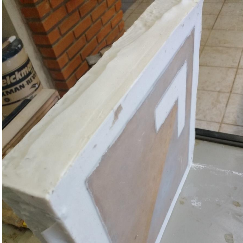
Figura 90: Molde pronto com o protótipo.
