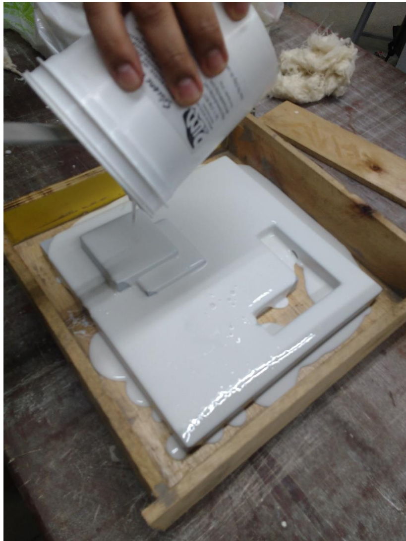
Figura 80: Primeira parte de silicone aplicada.
