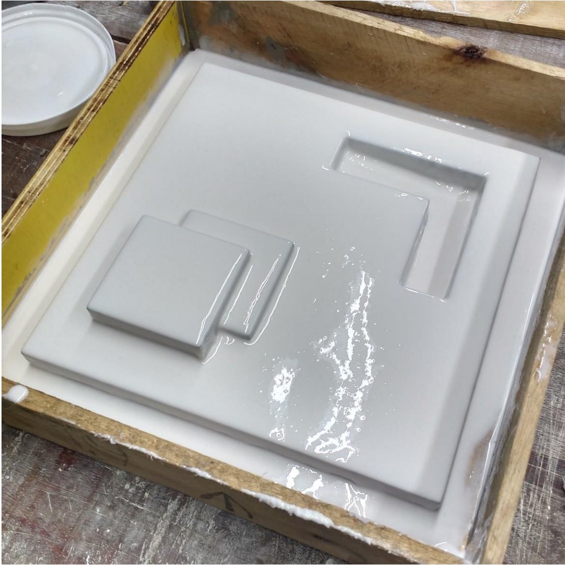
Figura 81: Primeira camada de silicone.
