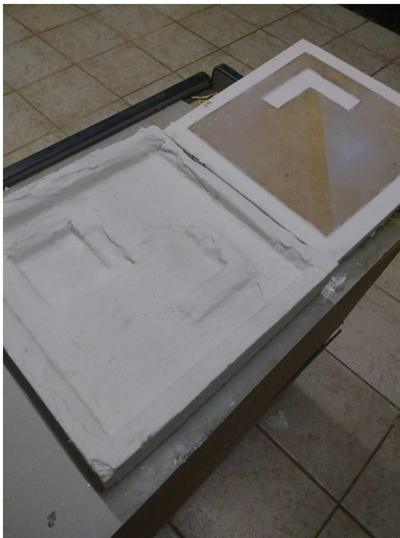
Figura 91: Separação entre o gesso e o silicone.
