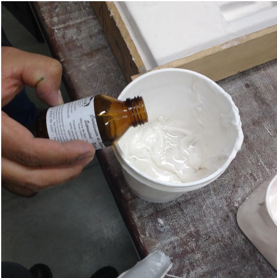
Figura 78: Aditivo sendo adicionado em 1/3 do silicone.
