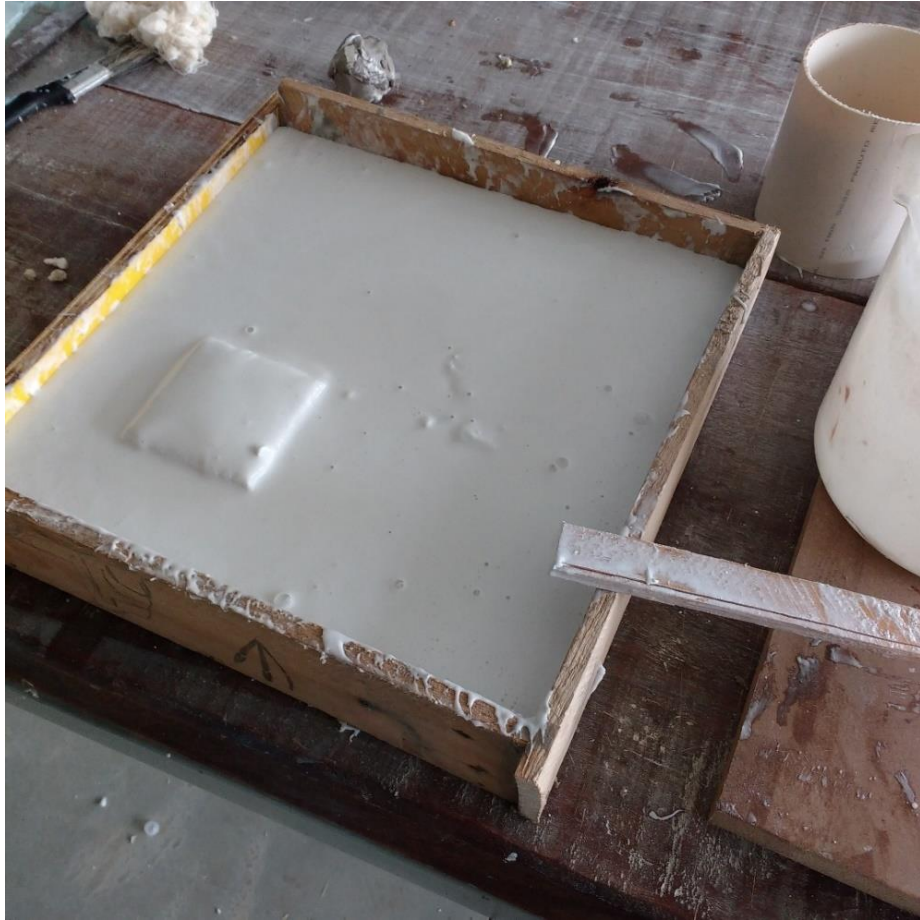
Figura 87: Enchendo a estrutura com o gesso.
