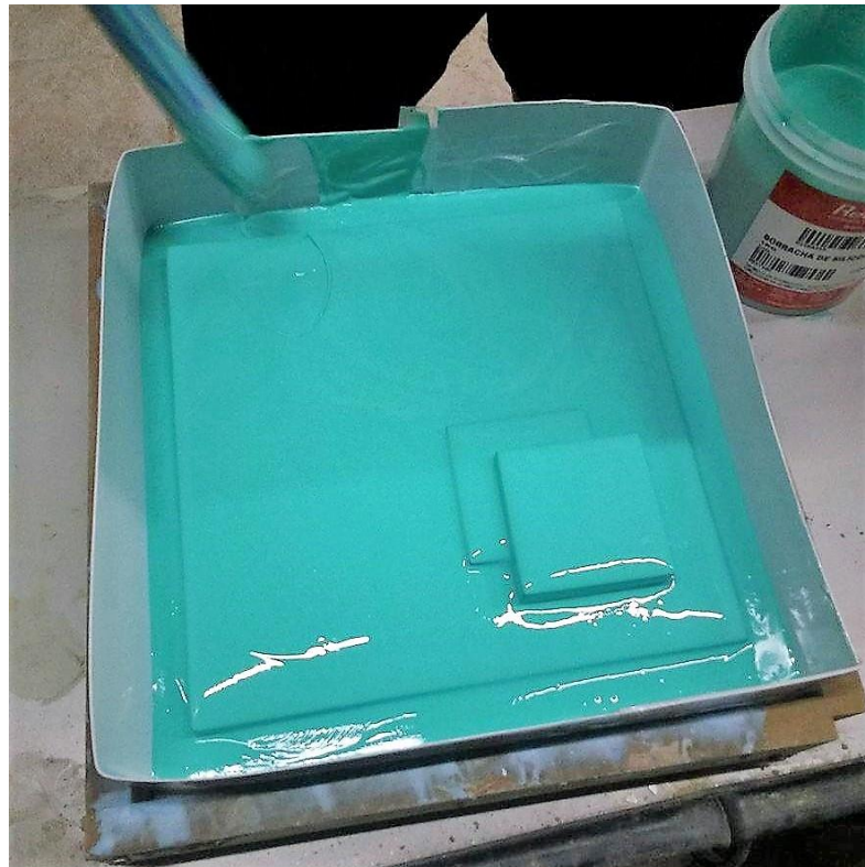
Figura 61: Superfície do protótipo coberta pelo silicone.
