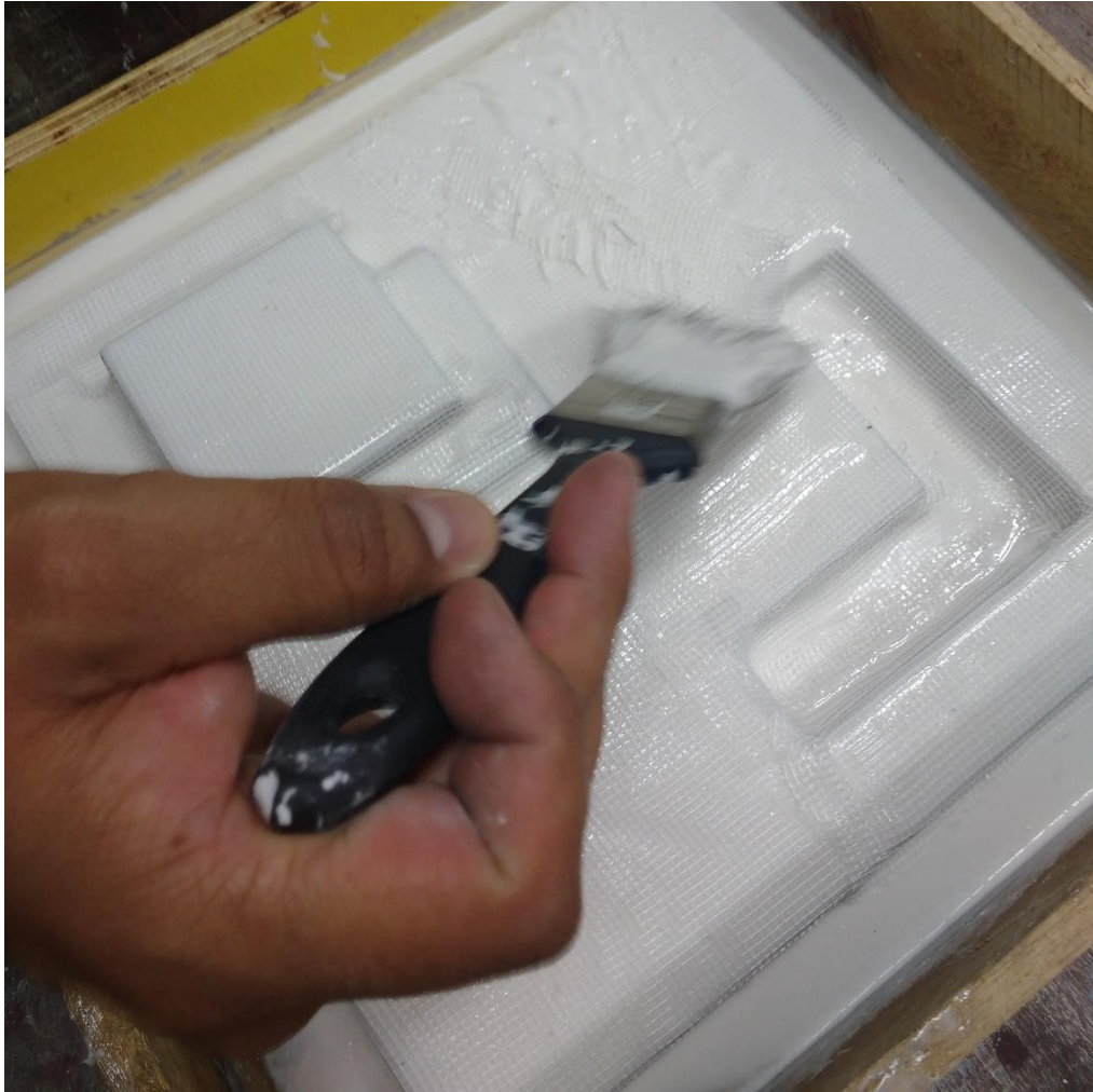
Figura 84: Espalhando o silicone sobre as malhas de poliéster.
