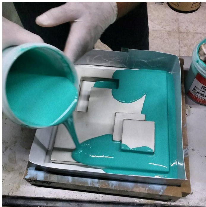
Figura 60: Enchimento da estrutura com silicone.
