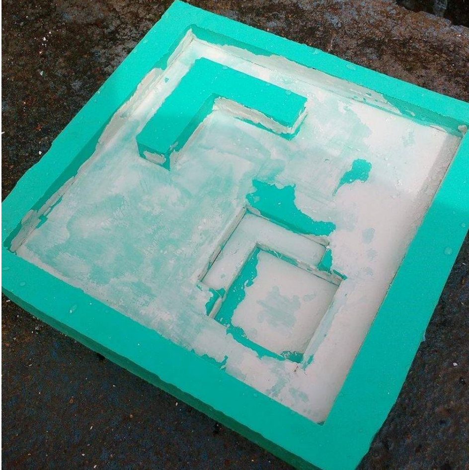
Figura 66: Forma após retirada do protótipo.
