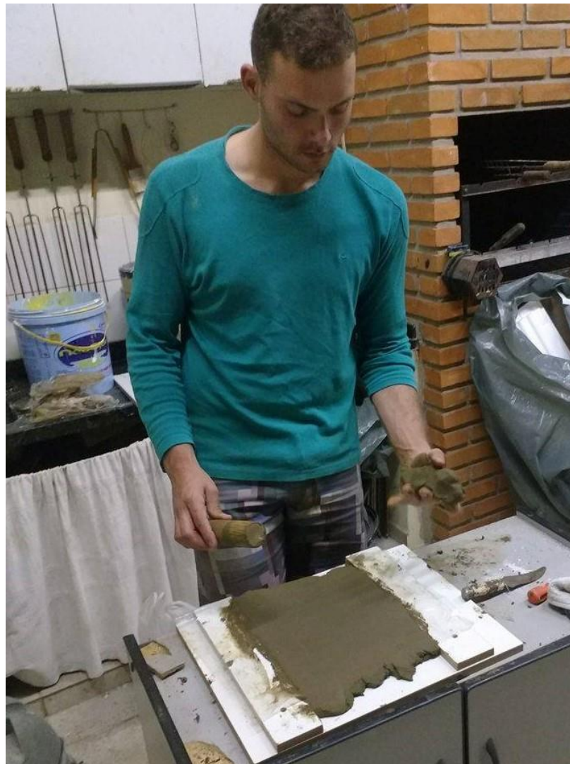
Figura 38: Primeira peça sendo moldada no MDF.
