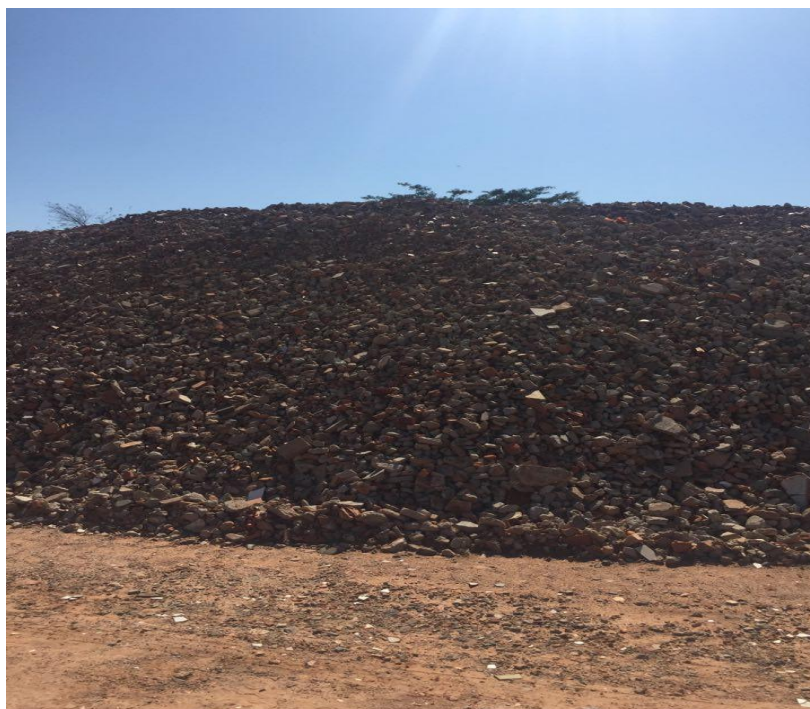
Figura 4: Aglomerado de britas nº2
