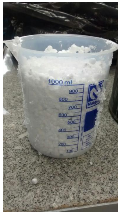
Figura 13: Agregado leve utilizados nos traços conforme tabela 03.
