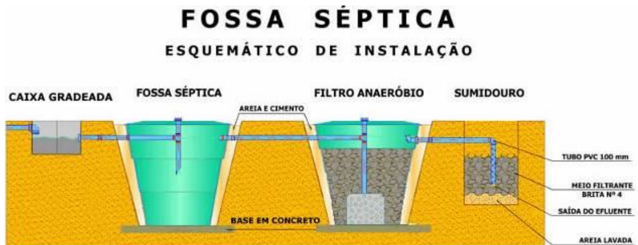
Figura 24: Fossa séptica modelo de instalação
